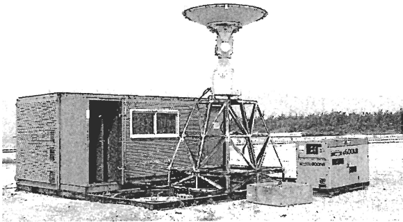
下地島（写真上）と多良間島（同下）に設置された降雨観測用ドップラーレーダー（写真は坪木理学博士提供）
